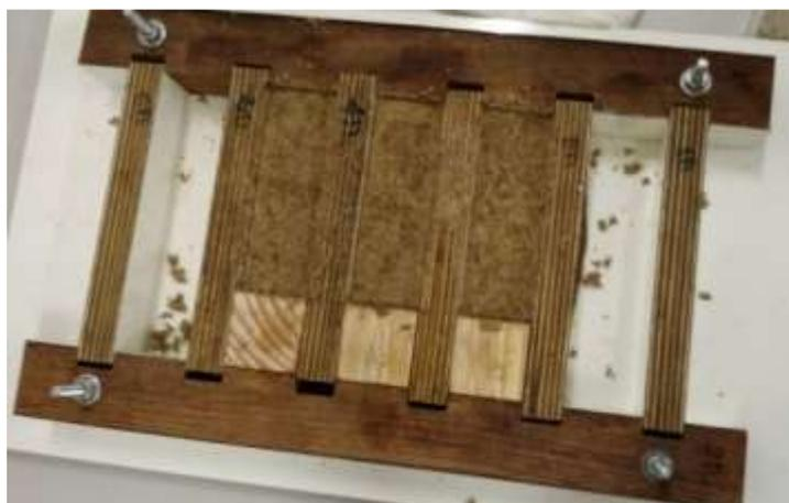
**Figura 7:** Corpo de prova de tração na flexão
