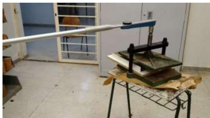
**Figura 6:** Prensagem dos corpos de prova
