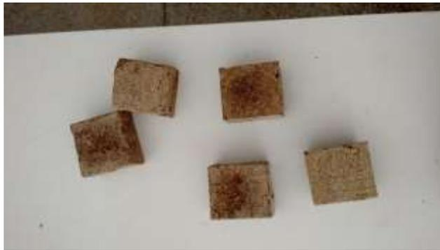
**Figura 8:** Corpo de prova de compressão prontos para o ensaio
