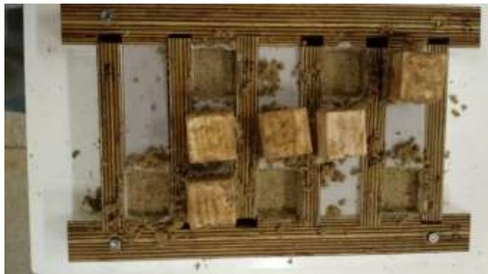
**Figura 5:** Corpo de prova de compressão
