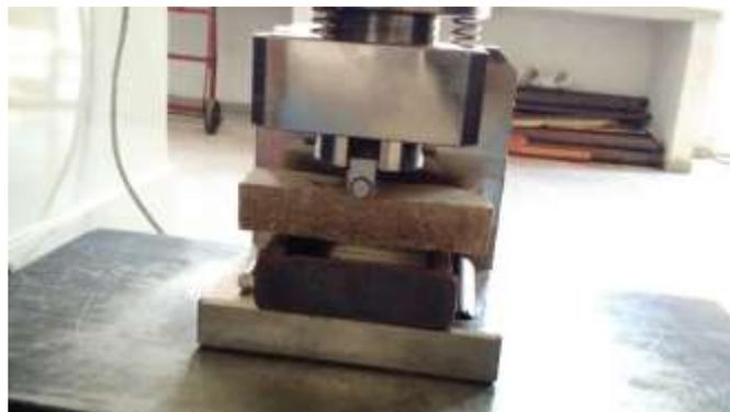
**Figura 12:** Detalhe do aparato na base do corpo de prova no ensaio de flexão
