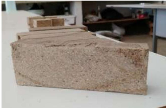
**Figura 11:** Corpos de prova de flexão prontos para o ensaio
