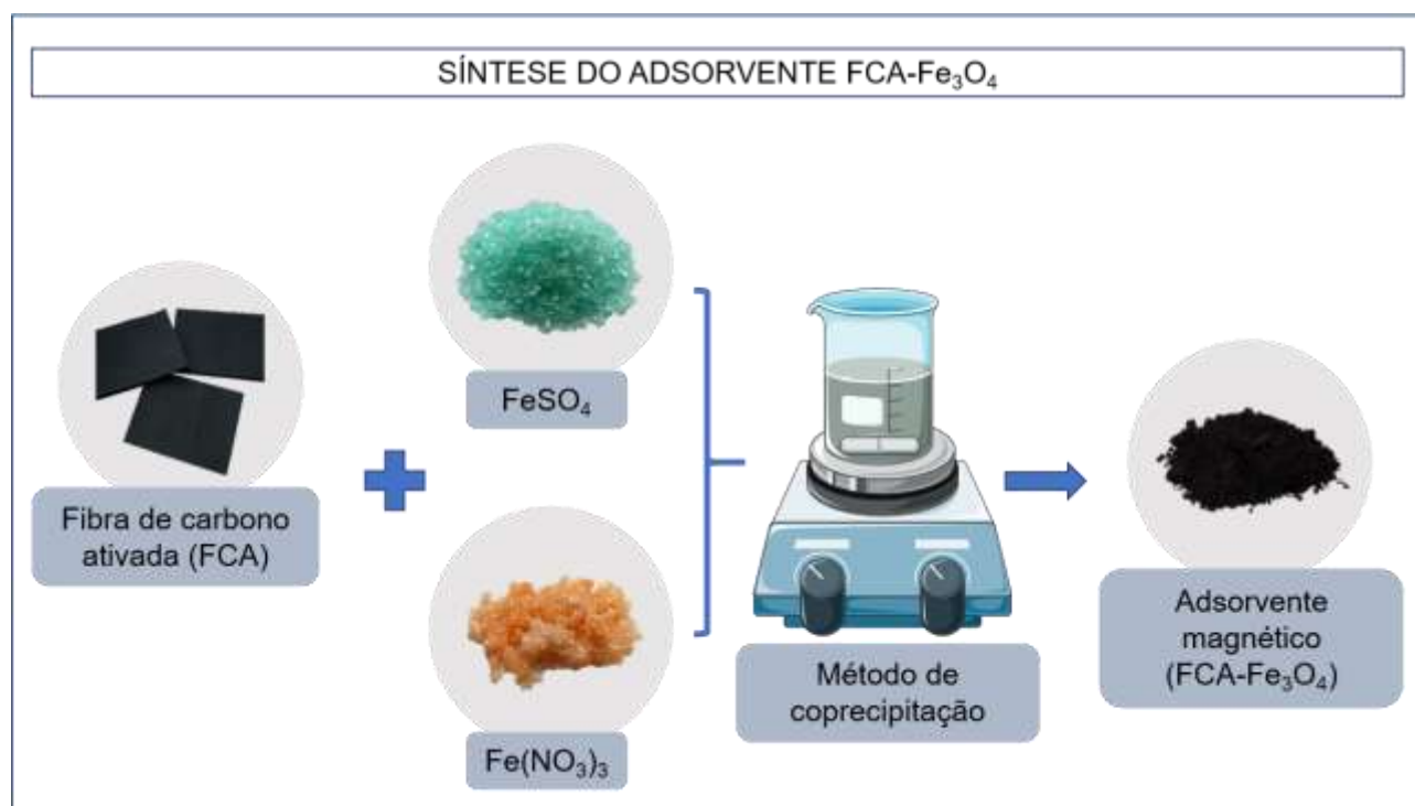
Figura 1: Representação da metodologia experimental de síntese do adsorvente magnético (FCA-Fe 3 O 4 )
