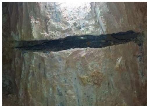
**Figura 1:** Deslocamento na estaca causado pelo ensaio bidirecional
