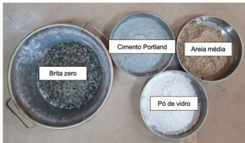
Figura 1: Materiais para a confecção do concreto Fonte: Dados da pesquisa
