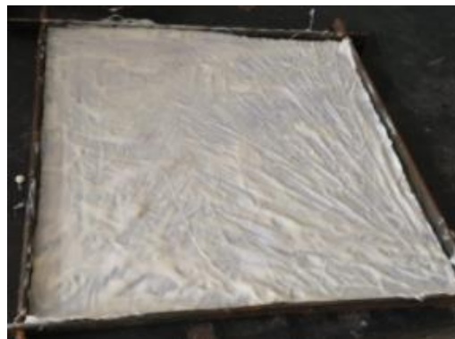
Figura 1: Camadas de tecido de algodão impregnadas pela mistura de resina fenólica. Fonte: própria
