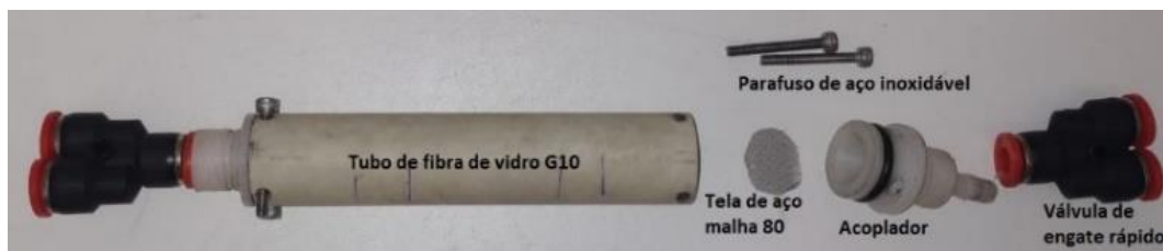
Figura 1: Montagem final do leito fixo magnético
