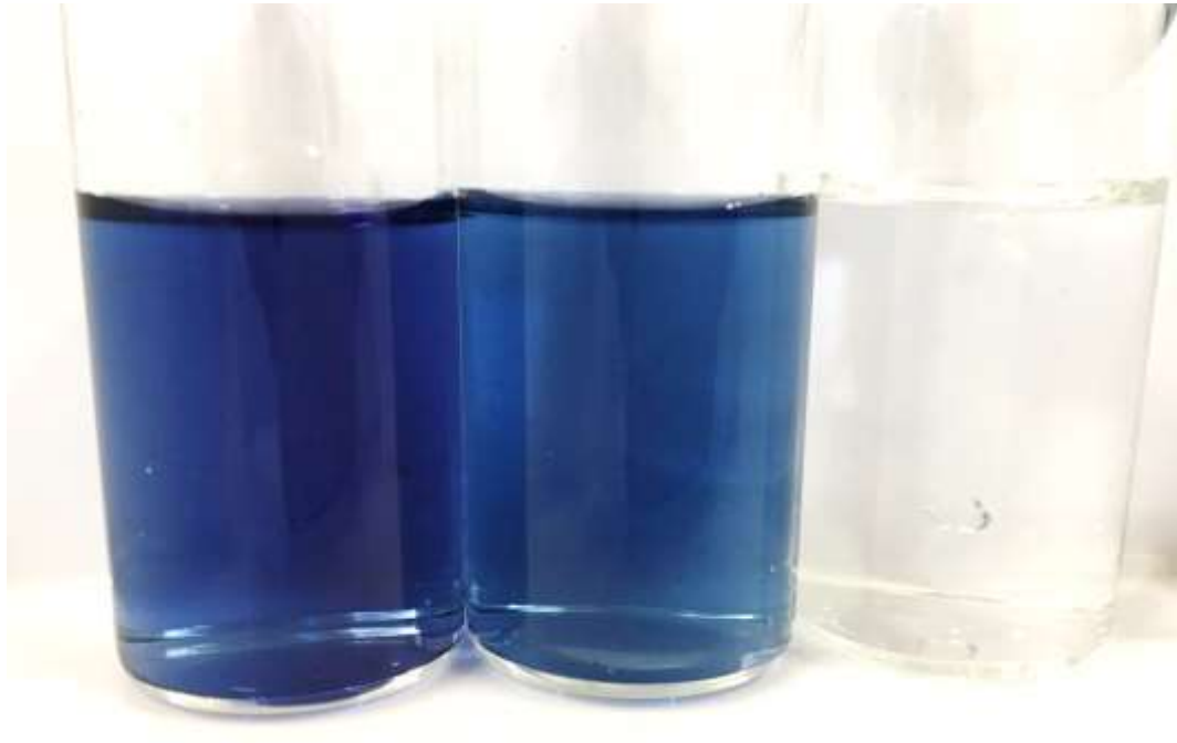
Figura 4: Solução de PR5 (a) inicial, (b) após coagulação/floculação e (c) após microfiltração com o coagulante albumina.
