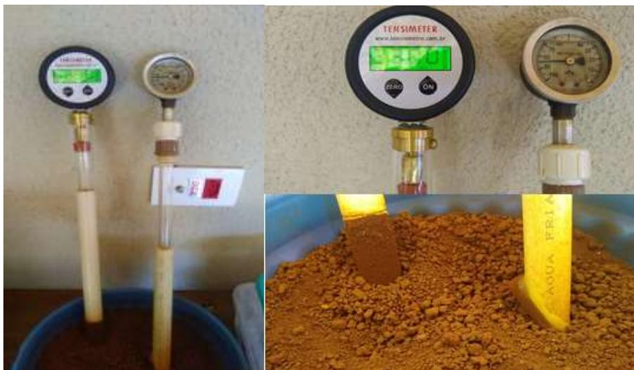
**Figura 2:** Tensiômetros com cápsula comercial (esquerda) e com pastilha artesanal (direita), no limite da capacidade operacional, mostrando equivalência.
