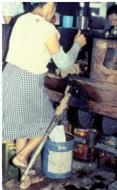
**Figura 16.1** Corte manual de castanha. A cortadora fica em pé sobre um pequeno banco de madeira. Aciona o pedal que irá mover a lâmina que corta a castanha. Essa posição, durante várias horas por dia, gera problemas osteomusculares causados nesse tipo de corte.
