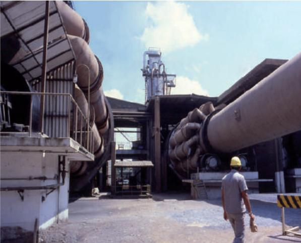
**Figura 4.1** Forno tubular onde se faz a queima do clínquer (mistura de calcário + argila + gesso). A temperatura de queima ultrapassa 1.400° C.
