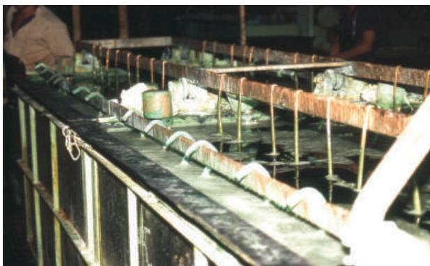
**Figura 8.1** Tanque de niquelação. Observe as barras central e laterais, onde são colocadas as "gancheiras" para que as peças nelas fixadas sejam niqueladas após a passagem da corrente elétrica. Obs.: estas gancheiras são colocadas e retiradas manualmente, havendo risco do contato frequente com o banho. Existe, ainda, a possibilidade de contato da região abdominal do trabalhador com a borda umedecida do tanque.
