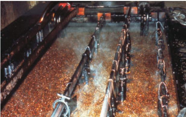
**Figura 9.1** Tanque de cromação aberto. Não há ventilação exaustora nas bordas do tanque. Névoas emanadas no processo de cromação podem atingir as vias aéreas superiores e causar perfuração no septo nasal em trabalhadores susceptíveis. Foto cedida pelo professor Luiz Carlos Morrone.
