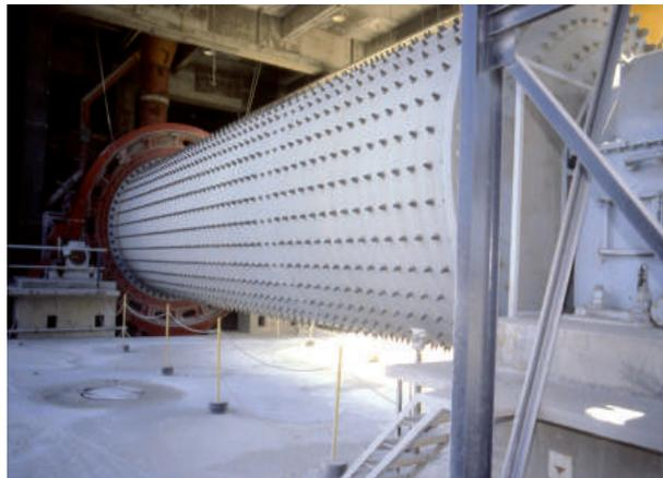
**Figura 4.2** Moinho de bolas. O clínquer é moído no moinho de bolas e reduzido a fino material particulado – cimento em pó.
