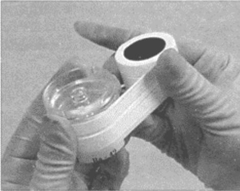
**Figura 4a** – Vedação com fita tipo teflon
