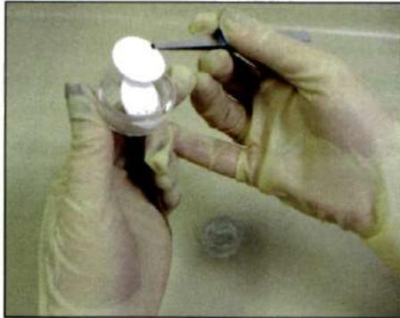
**Figura 6.** Retirada do filtro amostrado do frasco
