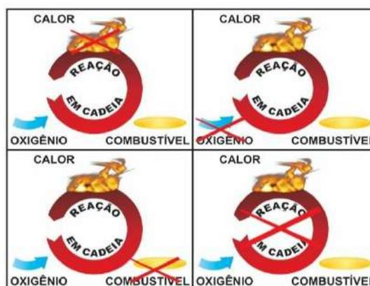
Figura 16: Formas de extinção do fogo
