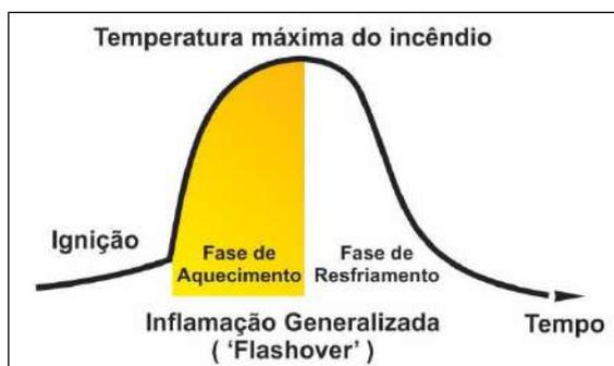
Figura 17: Curva temperatura – tempo de um incêndio
