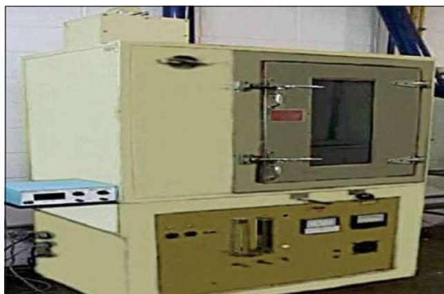
Figura 31: Câmara de densidade óptica fechada
