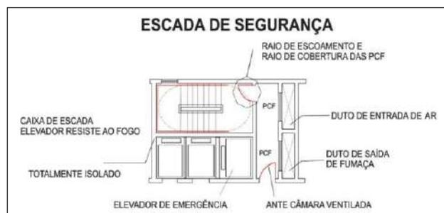
Figura 40: Escada e elevador à prova de fumaça
