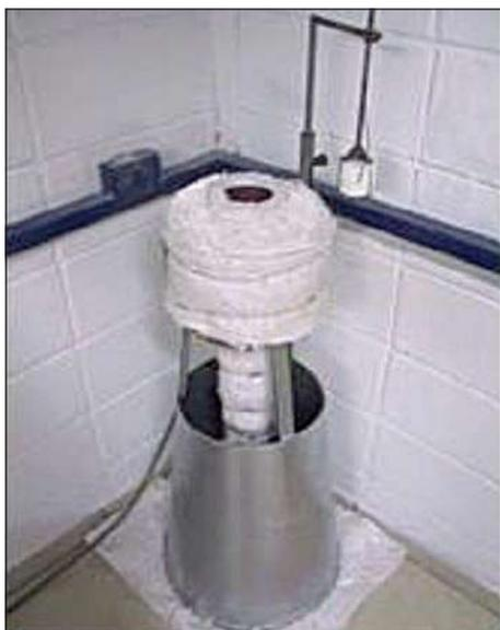
Figura 32: Forno cerâmico
