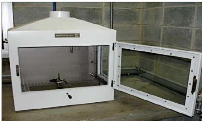
Figura 34: Determinação da ignitabilidade dos materiais
