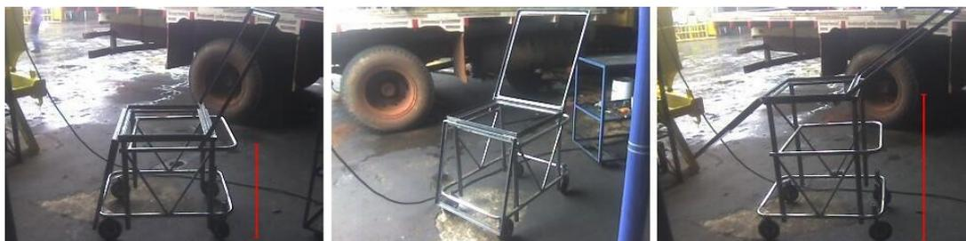
**Figura 3:** Estrutura da cadeira desenvolvida em aço 1020 tubular (2007).
