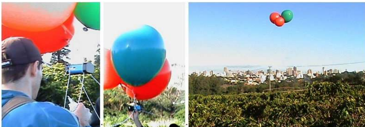
Figura 2. Montagem e utilização do balão na captura de imagens.
