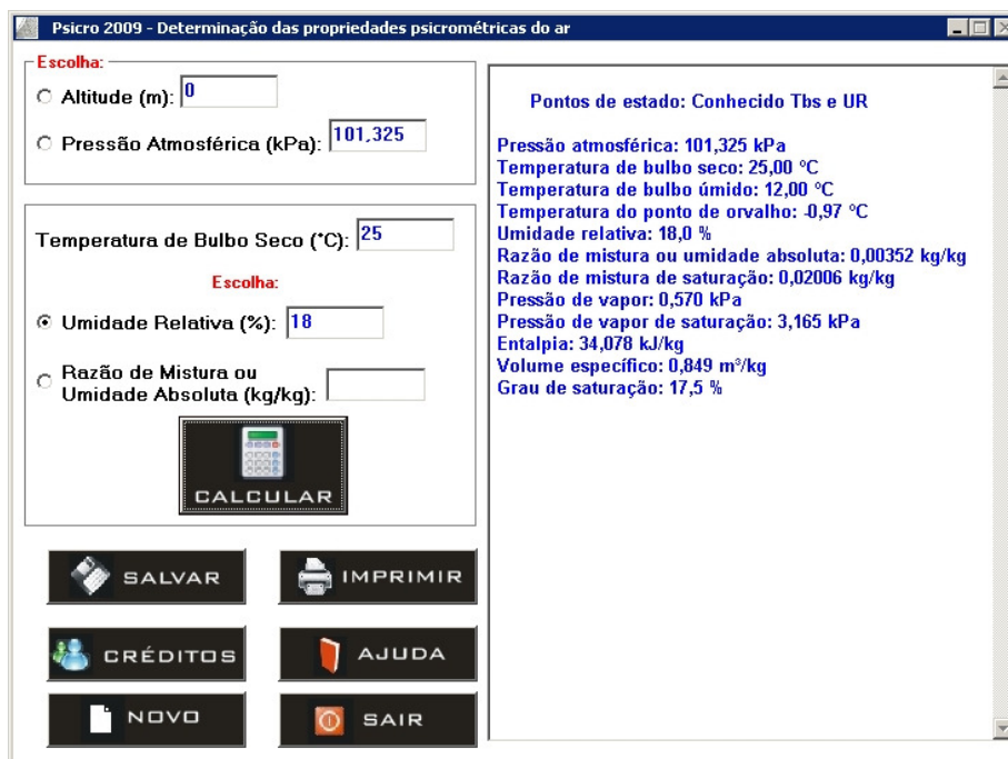
Figura 2. Janela principal do programa com exemplo de determinação das propriedades psicrométricas.
