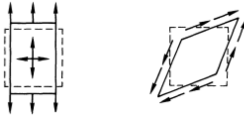
Figura 1 - Comportamento de um material ortotrópico de acordo com as tensões aplicadas sobre ele (JONES, 1975, p.13).
