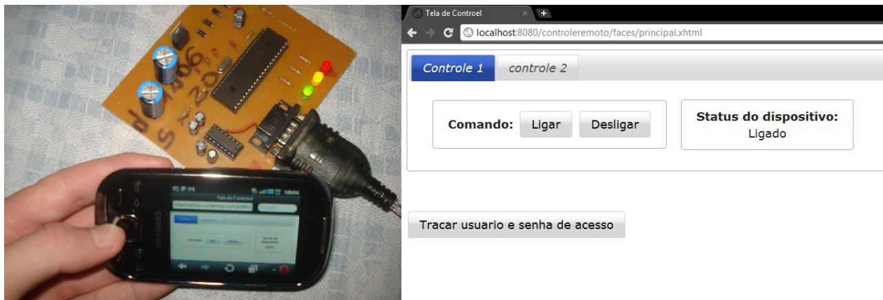
Figura 3 - Aparelho celular acessando e controlando o sistema (esquerda) e acesso de um computador pessoal ao sistema (direita)
