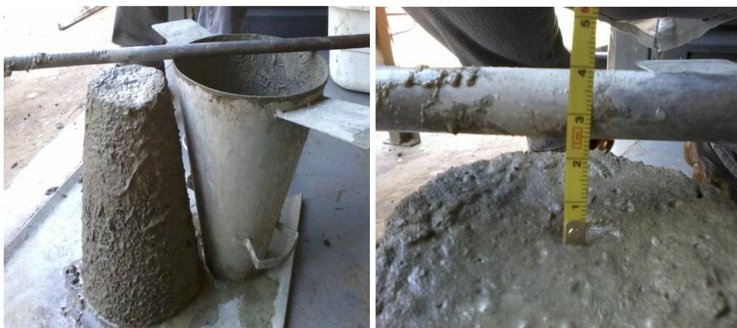
Figura 5. Slump-test do traço "com substituição de 100 gramas"
