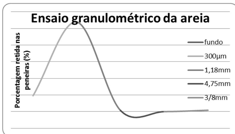
Figura 3. Curva granulométrica do agregado miúdo (areia)
