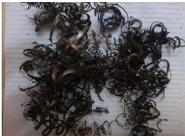
**Figura 2.** Fibra de aço “cavaco de torno”, AUTOR
