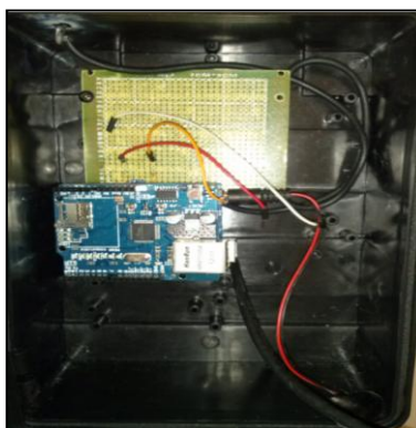
Figura 2: Caixa hermética para proteção dos circuitos eletrônicos.
