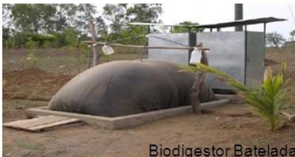
**Figura 3:** Biodigestor Batelada
