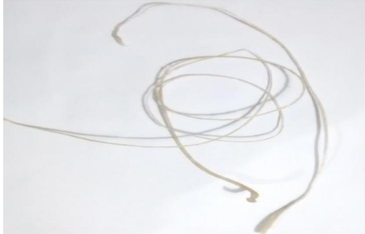
Figura 4: Blendas de amido termoplástico e polietileno via extrusão.
