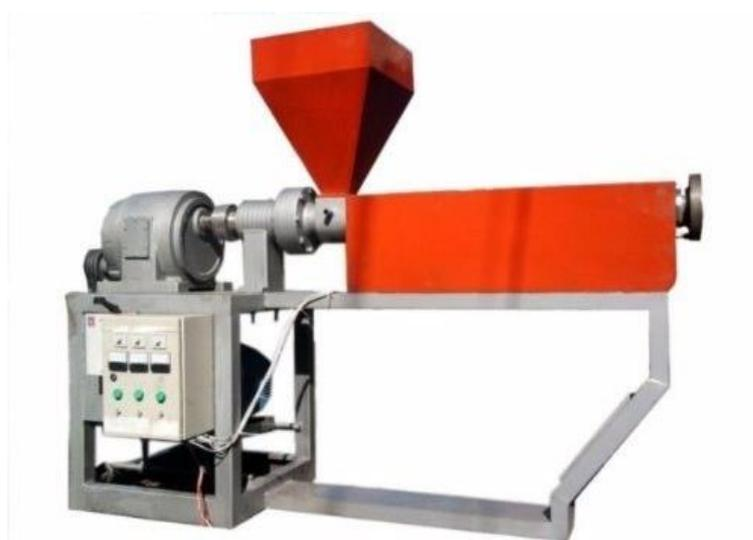
**Figura 3 - Extrusora de 60mm rosca simples.****Fonte:** Elaborada pelo Autor.
