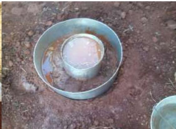
Figura 2: Dois anéis instalados
