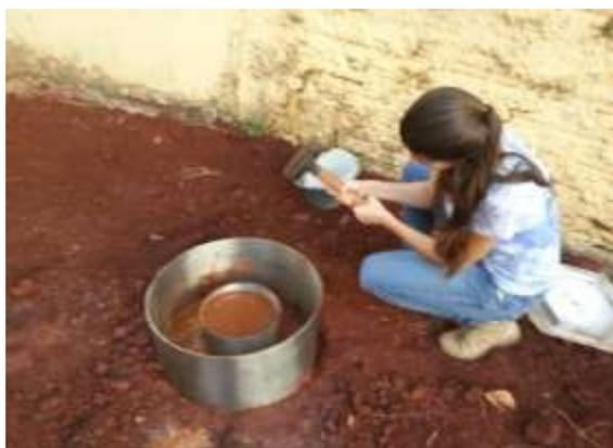
Figura 1: Infiltrômetro sendo cravado no solo
