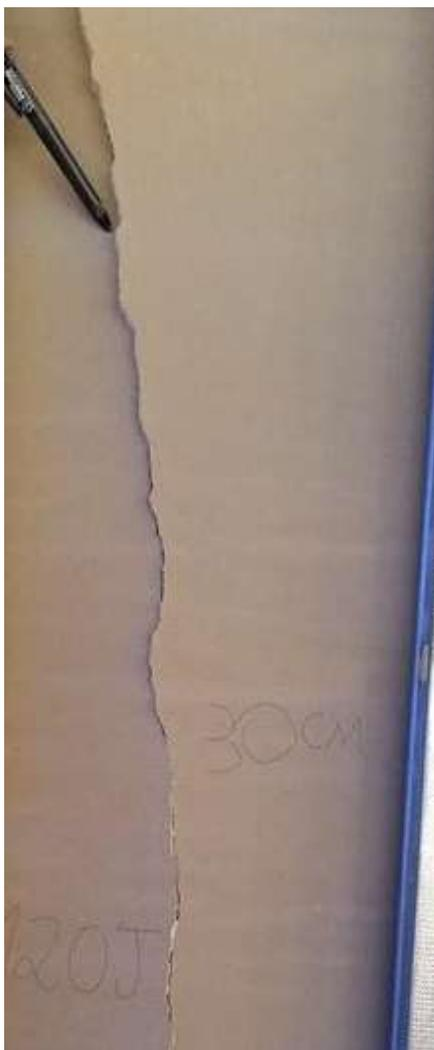
Figura 4: Detalhe da parede de gesso com espaçamentos dos montantes de 60 cm após o impacto com 15 cm de altura e energia de 60 J.
