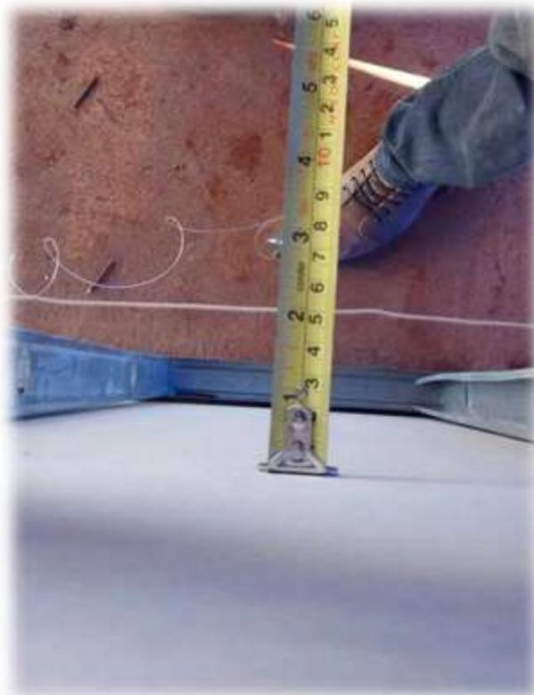
Figura 2: Detalhe do posicionamento dos equipamentos para a medição da deformação (imagem de demonstração).
