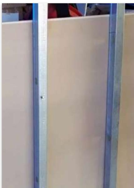
Figura 3: Detalhe da parede de gesso com espaçamentos dos montantes de 30 cm após o impacto com 15 cm de altura e energia de 60 J.
