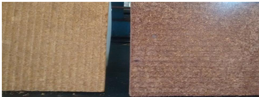
Figura 6: Resultado do ensaio de envelhecimento, painéis A (50/50) e B (30/70). Fonte: Autor (2015).
