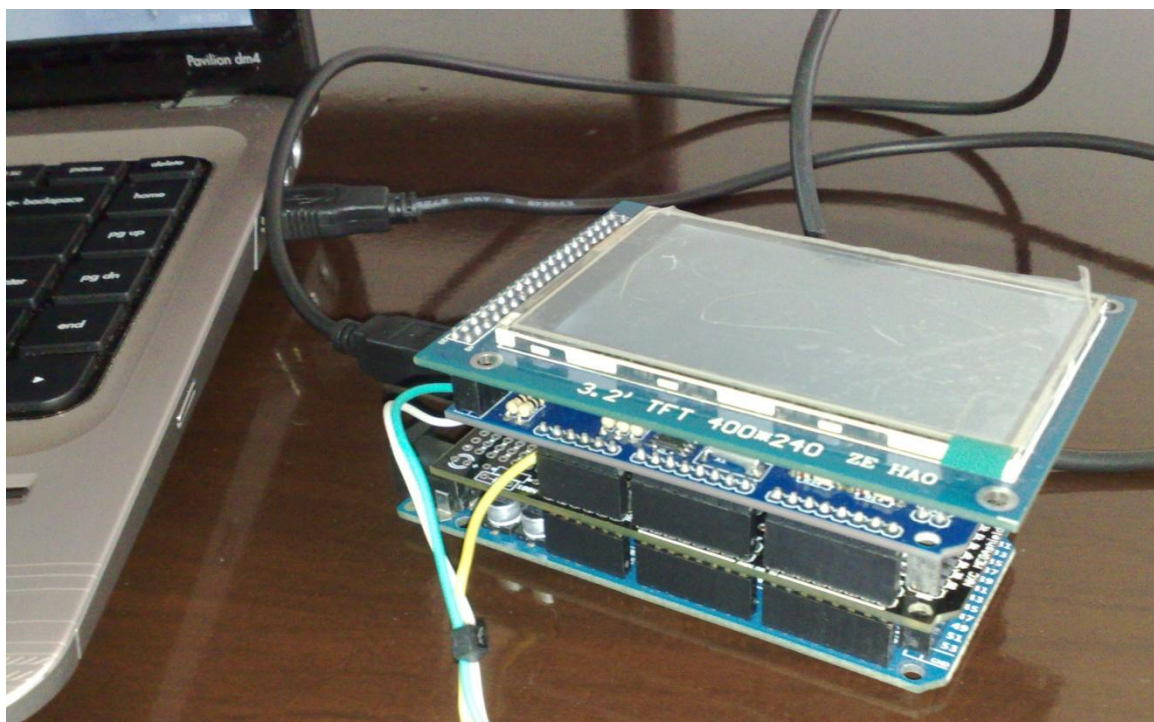
Figura 3: Imagem do módulo de controle com conectado ao computador. De cima para baixo: Display TFT ; Real Time clock ITDB02 ; Proto Shield ; Arduino Mega 2560 .
