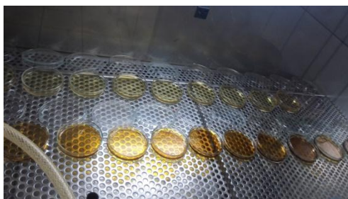
FIGURA 11 – Meios vazados na capela de fluxo laminar
