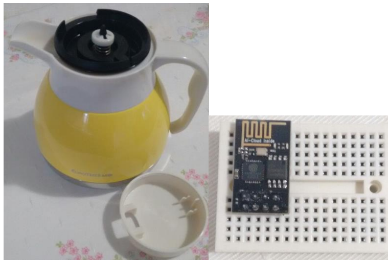
Figura 3 – Novo modelo de garrafa adquirida por questões estratégicas de prototipação, onde os elementos serão escondidos dentro da tampa que necessitará de modificações. Módulo ESP8266 acoplado em uma mini breadboard para início de testes.
