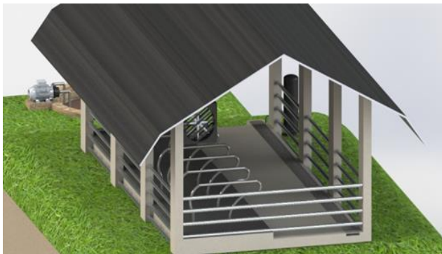
Figura 1: Sistema de captação lateral no Freestall
