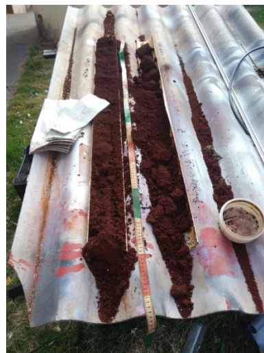
Figura 2. tubos cortados lateralmente para retirada das amostras.
