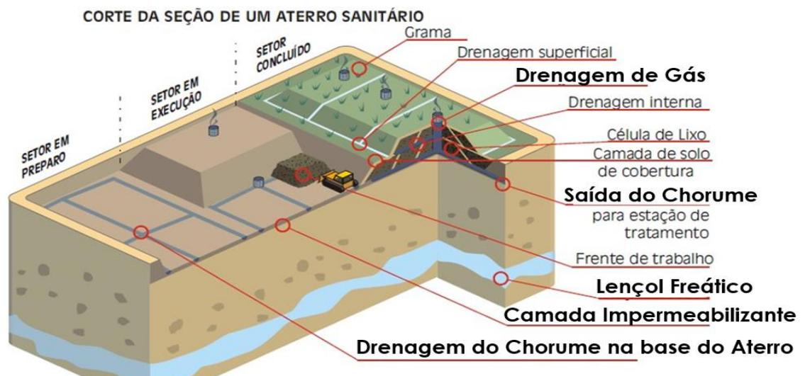
**Figura 6:** Ilustração de um aterro sanitário
