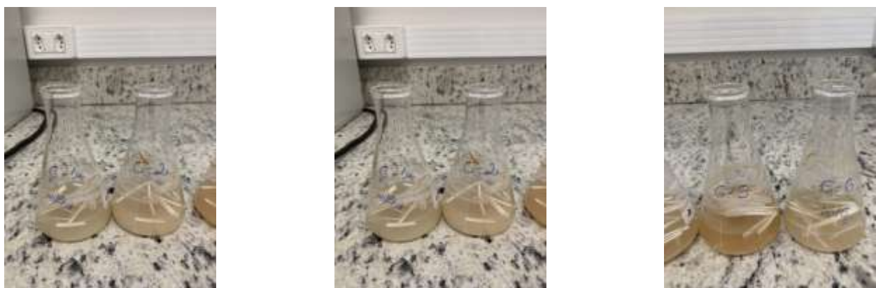
Figura 3. Amostras de penas de frango parcialmente hidrolisadas com o uso de papaína comercial (0,25 g/dL) ou extrato de mamão verde (0,25 g)
