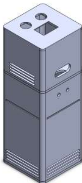
Figura 5: Vista isométrica da estrutura do termocirculador.
